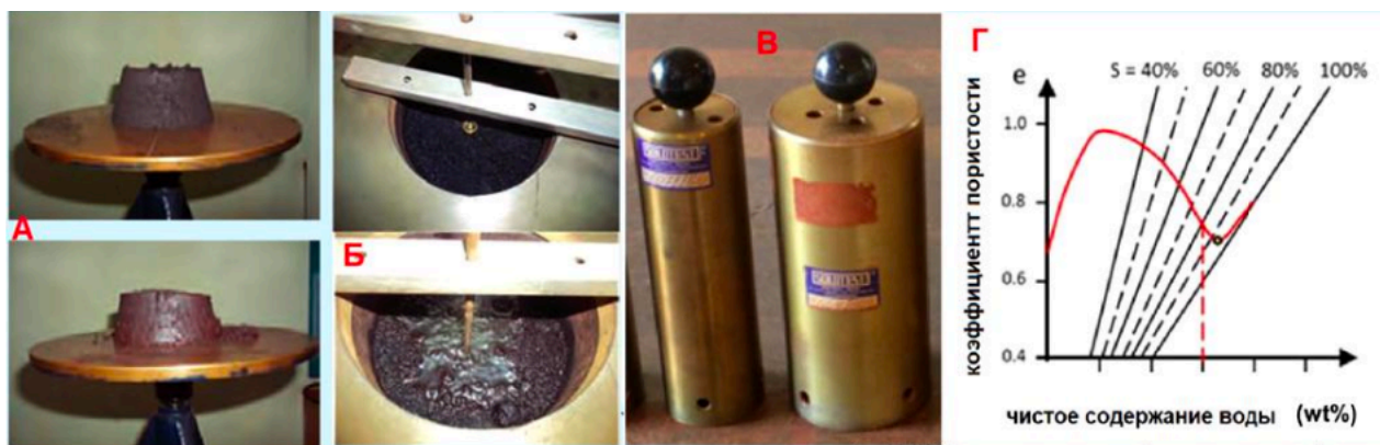
Рисунок 18 – Одобренные методы испытаний: А - на виброударном столе; Б - на пенетрацию; В - по методу Проктора-Фагерберга; Г - кривая уплотнения
