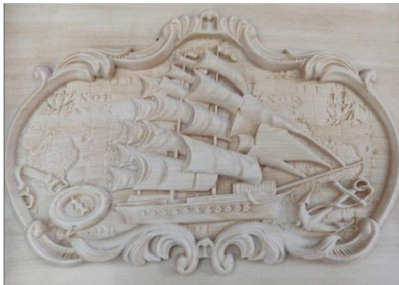
Рисунок 1 – Деревянное панно, выполненное на фрезеровальном станке с ЧПУ (трехмерная модель от интернет маркета AliExpress)
