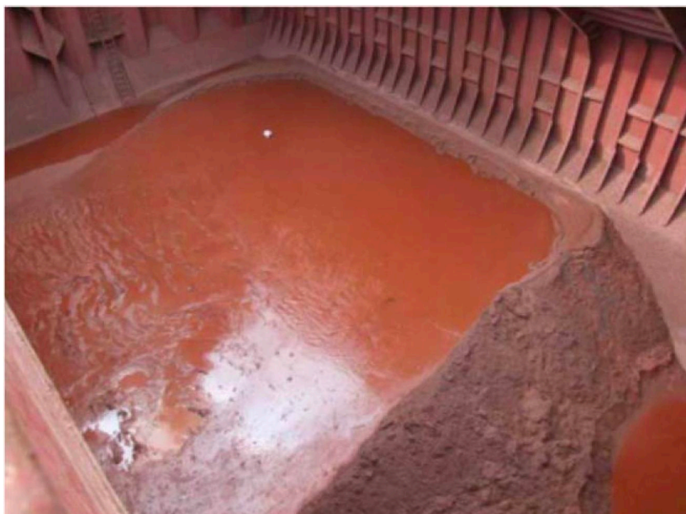
Рисунок 24 – Динамическая сепарация боксита: на фотографии видны две свободные поверхности, каждая из которых занимает разный уровень, а склон водораздела выглядит более сухим и неповрежденным
